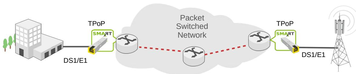
Figure 1: Mobile backhaul of DS1/E1 via Packet Network
